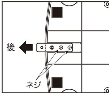
金具に付いているネジを外して、図のように後方に穴を一つずらして取付けて下さい。
